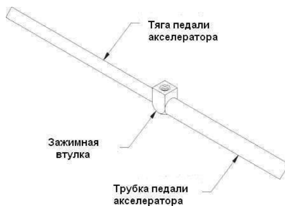
Рис. 16: Регулировка рычага педали акселератора
