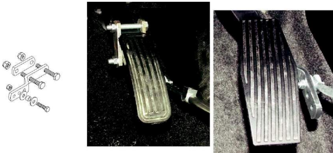
Рисунок 5: Установка крепление педали акселератора
