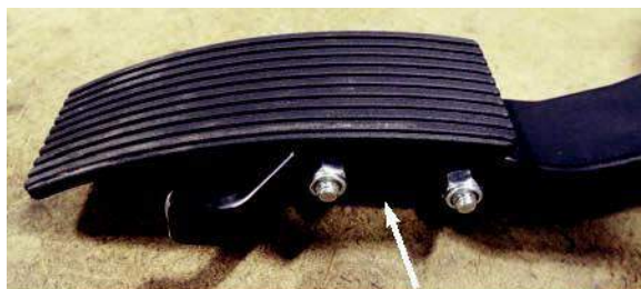
Рисунок 5: Установка крепление педали акселератора
